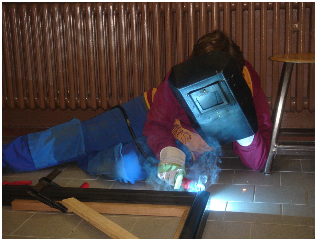
Schüler bei der Montage des Tischgestells für den Air-Hockeytisch
